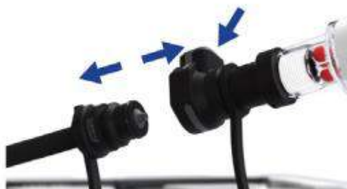
Рис. 19: Разъедините соединение
