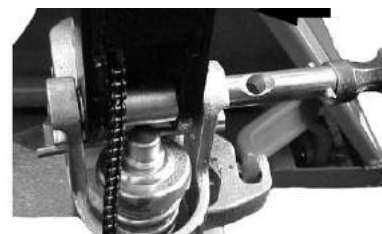
Рис.6: Сборка оси
