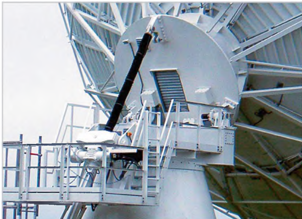
Высокопроизводительный винтовой домкрат HSE, конструкция 1, специальное исполнение, для подъема от 0° до 90° антенны 11,1 м
