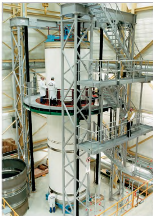
Фотография завода: MT Aerospace AG Монтажное подъемное устройство с кожухом силь- фона, ход прим. 9 м
