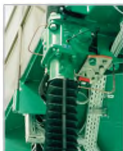
Фотография завода: MT Aerospace AG Монтажное подъемное устройство с кожухом силь- фона, ход прим. 9 м
